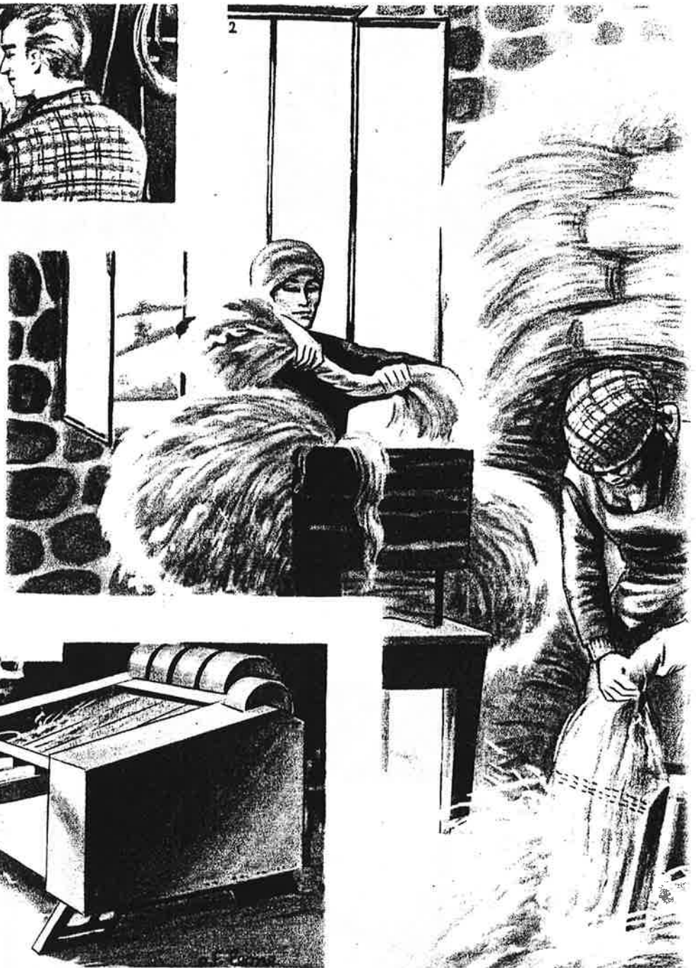
1) Als het vlas soepel is en ontdaan van ongerechtigheden wordt het netjes neergelegd. 2) Hierna wordt het nog op verschillende manieren bewerkt, licht in elkaar gedraaid, waardoor het pluis ontstaat. 3) De pluis komt in de kaardmachine, die het kamt en de vezels in de lengterichting samenvoegt, waardoor meer samenhang ontstaat. Bovendien wordt het enigszins in elkaar gedraaid, waarna het in de spinmachine gesponnen kan worden.
